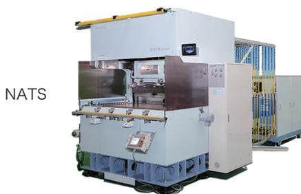
NATSは、熱と真空圧によりフィルムに印刷されたデザインのみを製品に転写・ラミネートする。
