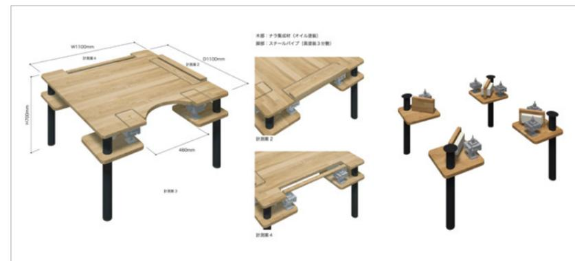
手に加わる、荷重を計測する実験台の試作機
